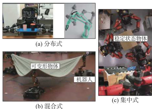
图 10 固定机械臂操作的控制架构
