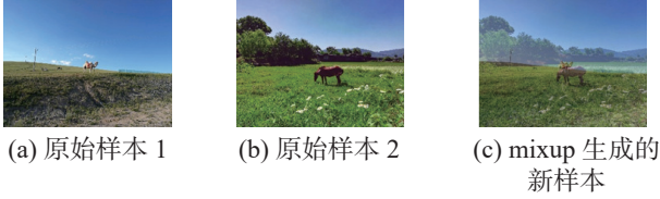
图 3 mixup 算法图像生成示意
