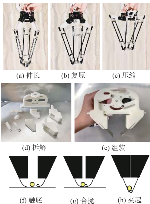
图3 分拣平台的抓取机构设计
