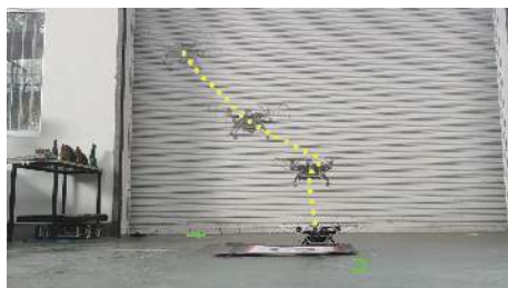
图 12 无人机降落至速度为 0.05~0.1m/s 的平台
