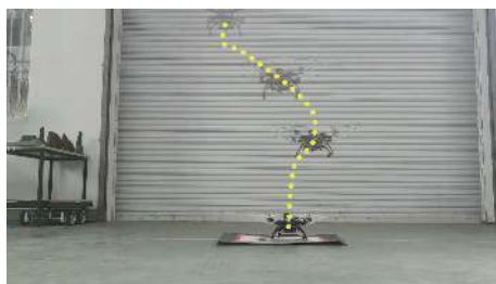
图 11 无人机(实体)降落至静止平台
