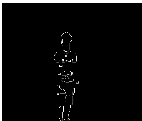
图4 Canny 边缘检测结果
