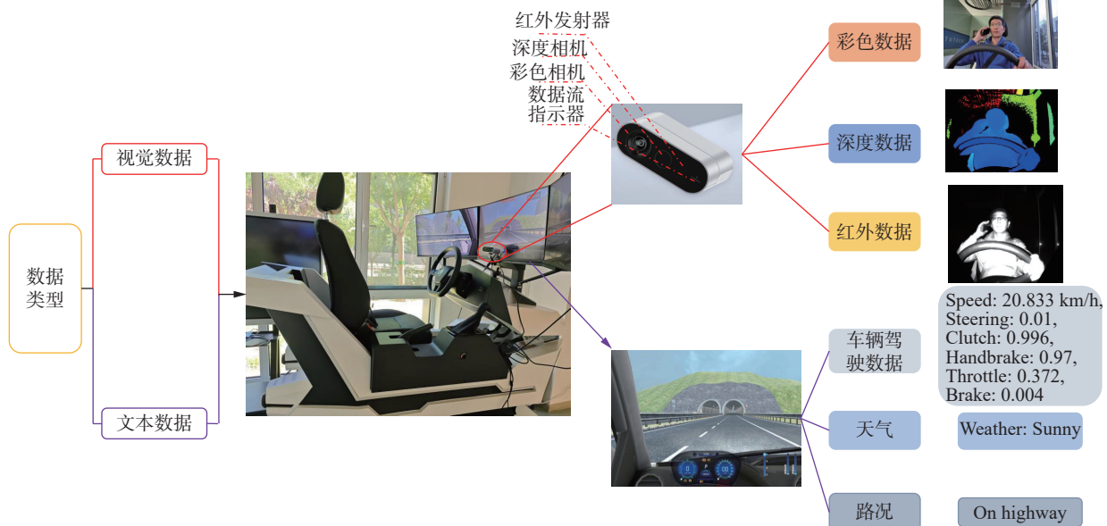
图 1 混合模态数据同步采集系统
