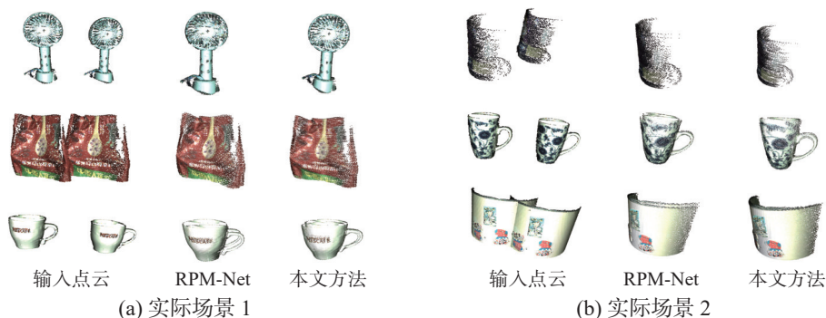
图 11 自制点云数据配准结果
