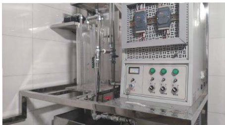
图3 水箱控制系统实验设备
