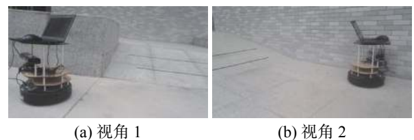
图 7 斜坡图像采集装置 Fig. 7 Slope image acquisition device
