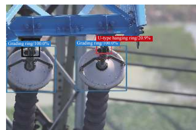
(c) 原始 SSD 模型 U 型挂环漏检结果
