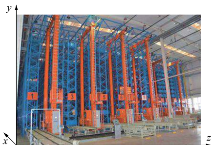
图1 自动化立体仓库布局 Fig. 1 Layout of AS/RS
