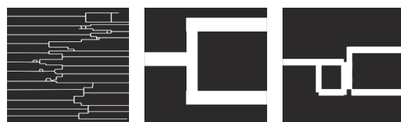
(a) 帘线交叉细化 (b) 第1类交叉结构 (c) 第2类交叉结构
