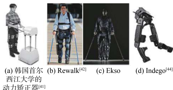
图 6 全下肢辅助的动力矫正器 Fig. 6 Whole lower-limb active orthosis
