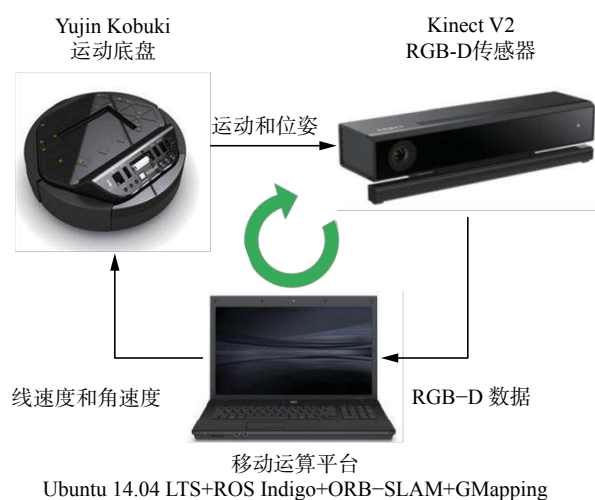
图 1 移动机器人系统的硬件平台
