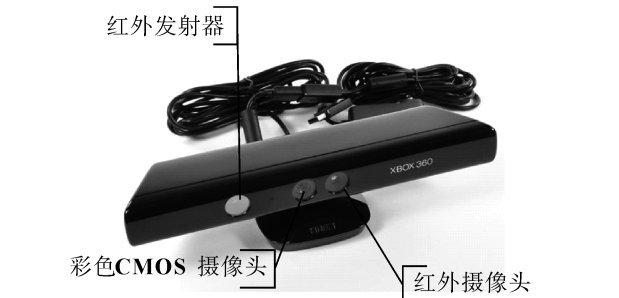
图 2 深度摄像机 Fig.2 The depth of the camera
