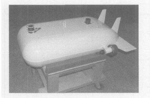
图 2 微小型水下机器人载体“微龙-号” Fig. 2 Mini underwater vehicle “WEILONG”
