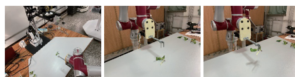
(a) 待机状态 (b) 夹取点上方 (c) 夹取成功
