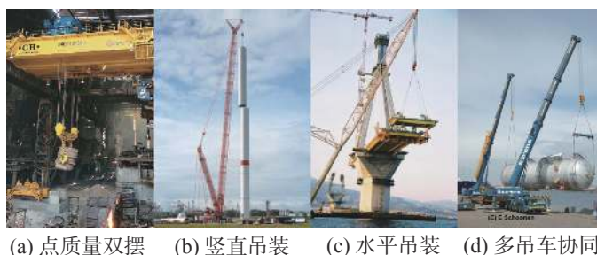
图1 大尺寸货物运送的主要吊装类型
