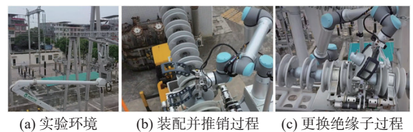
图 21 输电线路绝缘子更换实验
