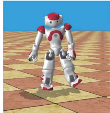
图 8 模型泛化角度值在 WEBOTS 仿真平台上的稳定步行 Fig. 8 Model generalized angle values for stable walking on the WEBOTS simulation platform
