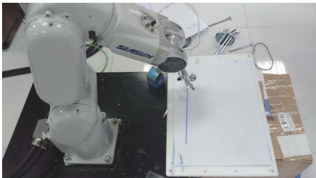
图 6 直线插补运动喷绘实验效果
