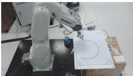
图9 圆弧插补运动喷绘实验效果
