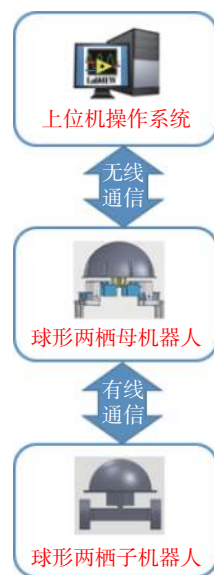
图 1 球形两栖子母机器人控制系统框图
