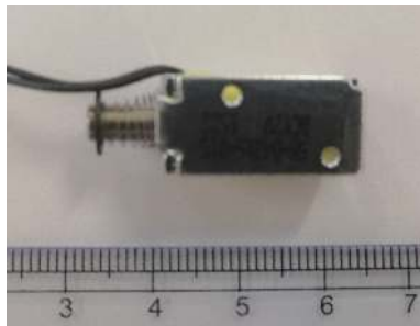
图 5 球形两栖子机器人释放装置硬件图
