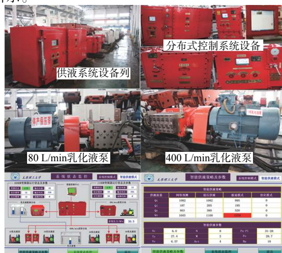
图10 智能供液系统部分设备与监控画面
