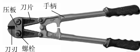
图 2 断线钳的结构
