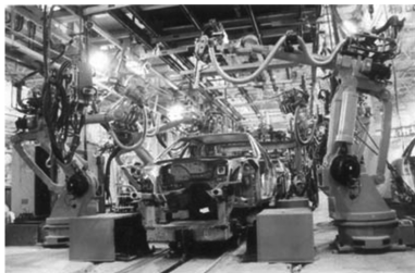
图5 汽车装配线上的工业机器人
