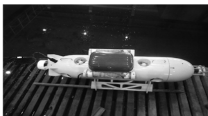
图 2 安装 SINS/DVL 组合导航系统的 AUV
