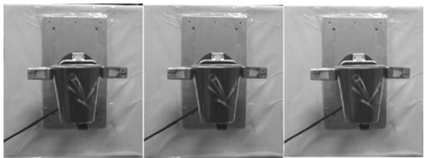
图 13 灵巧手抓取杯子
