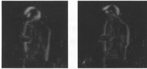
图 1 原始差分图像和经过腐蚀运算滤除噪声后的图像的对比
